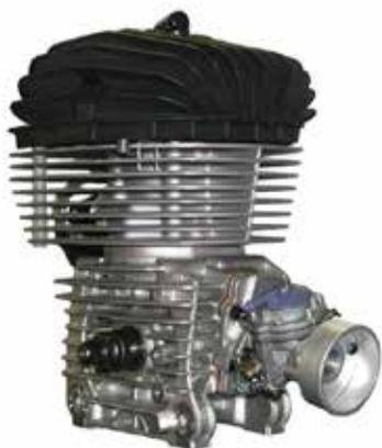
Existen dos tipos de sistemas de refrigeración: por aire o mediante líquido (agua o aceite).
